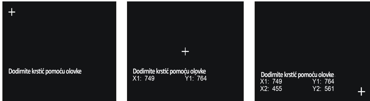
Tastatura na touch screen-u je već fabrički kalibrirana, ali ako u bilo kom trenutku dođe do nepreciznosti kod dodirivanja ekrana, može se izvršiti nova kalibracija. Da biste kalibrirali ekran pratite sledeću proceduru:
